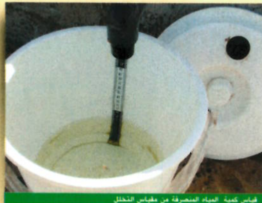
قياس كمية المياه المنصرفة من مقياس التخلل
