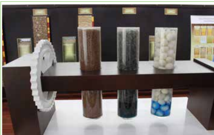
Le simulateur d'infiltration d'eau montre comment les tailles des particules de sol (sable, limon, argile) influent sur le taux d'infiltration.
